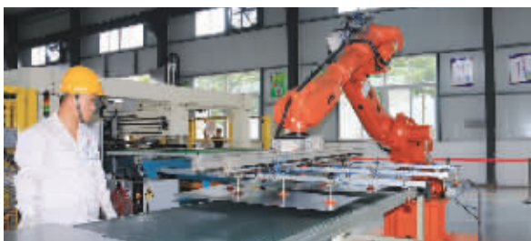
老工业基地转型走出良性路子——顺帅激光焊接科技(上海)有限公司技术工人正在用机器人设备对钢板进行激光拼焊
